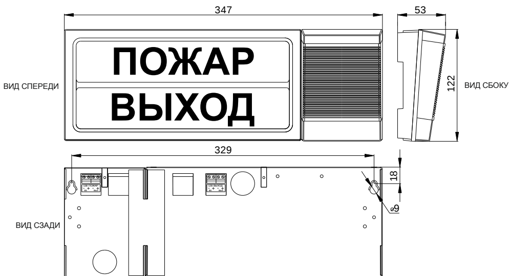
Рис.1 Внешний вид, габаритные и установочные размеры корпуса оповещателя
