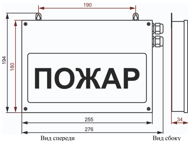
Рис. 1 Внешний вид, габаритные и установочные размеры корпуса оповещателя
