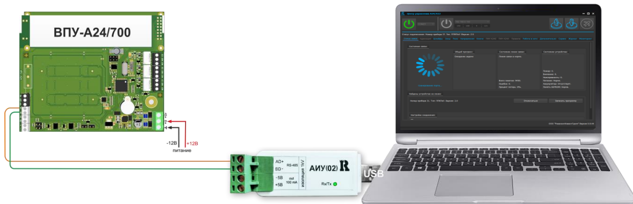
Рисунок.2. Схема подключения ВПУ-A24/700 к ПЭВМ через АИУ(02) для конфигурирования сетевого варианта работы приборов
