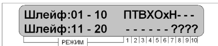
Рисунок 7 – Обзор состояния шлейфов сигнализации
