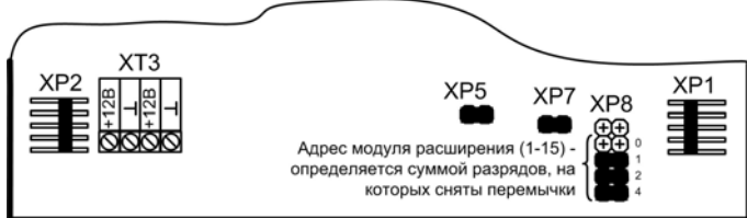
Рисунок 2. Расположение контактов и контактных колодок на печатной плате модуля расширения.
